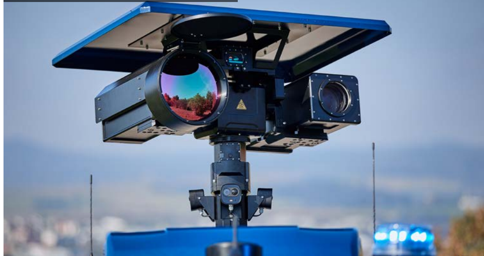
Výsuvný elektro-optický systém monitorovacího vozidla s termovizí
